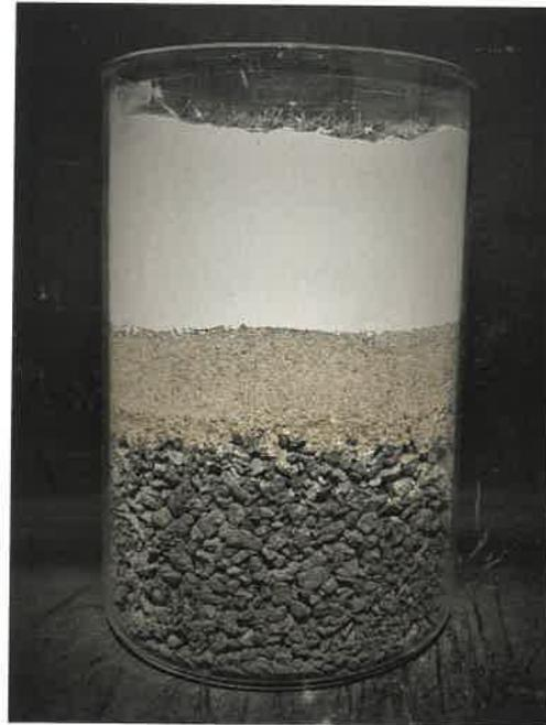
**Bild 5** Ausgangsstoffe für CONTEC Ferroplan, unten Hyperit (2/5 mm), mittig Feinsande (0,1/1,4 mm), oben Binder N und Stahlfasern
